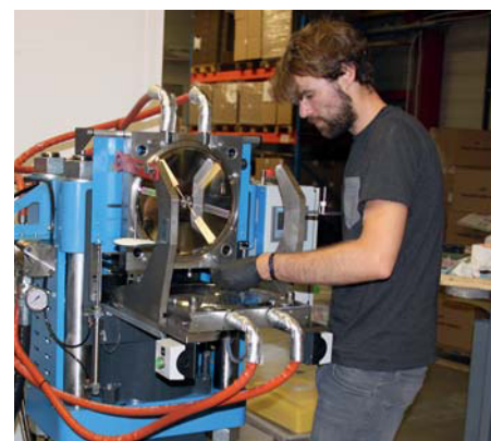
Bild 3: Alexander Terboven von intakt! bei der Einrichtung der 180g-Pressmaschine
