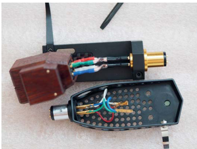
Die besonders starken ORTOFON-KABEL müssen den original SME-Drähten weichen.
