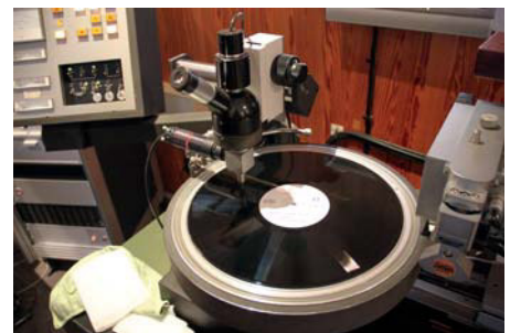
Bild 8: Testplatte TLP-1 auf dem DMM-Schneidegerät zur Begutachtung der Oberfläche
