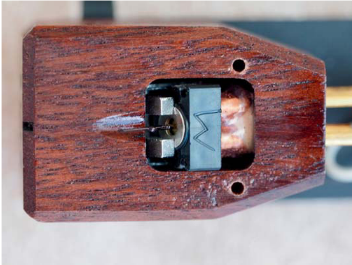
Der Lupenblick lässt deutlich die fest eingebauten Spulen und die spezielle Konstruktion des Nadelträgers erkennen.
