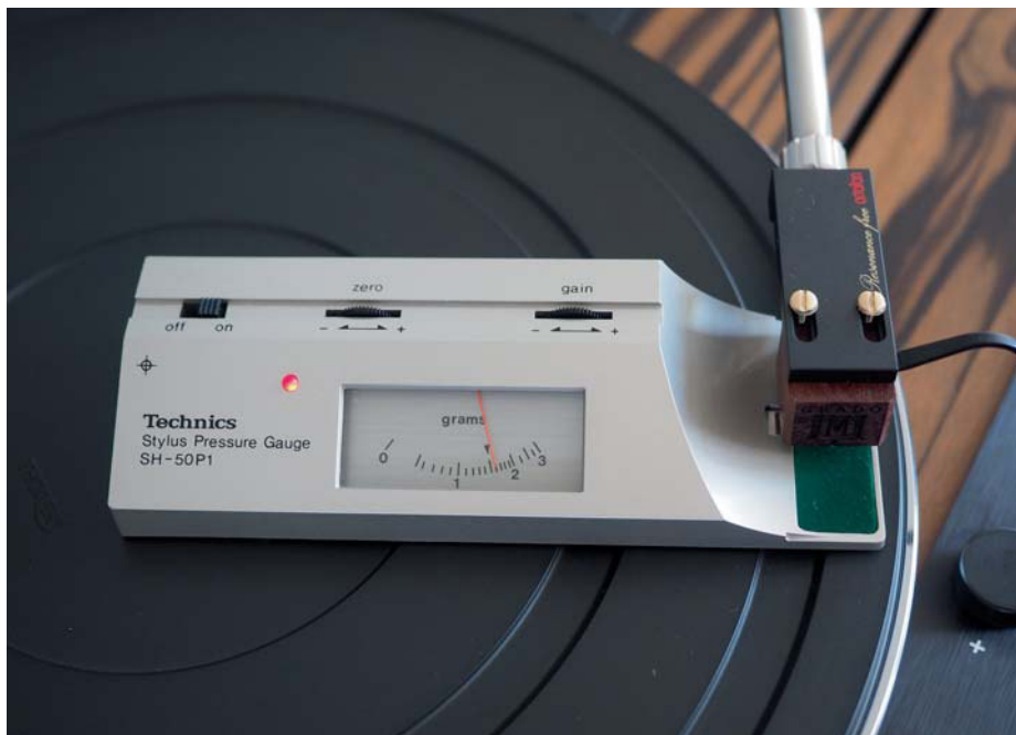
Das REFERENCE „Master 2“ soll zwischen 1,5 und 1,9 p betrieben werden, ideal für einen mittelschweren Tonarm.
