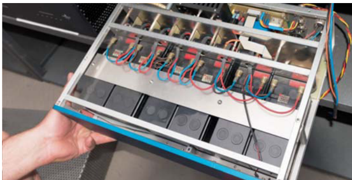
Als kleines Kraftwerk präsentiert sich die zugehörige separate Akkuvorsorgung zu einem Vorverstärker in Kanedaschaltung
