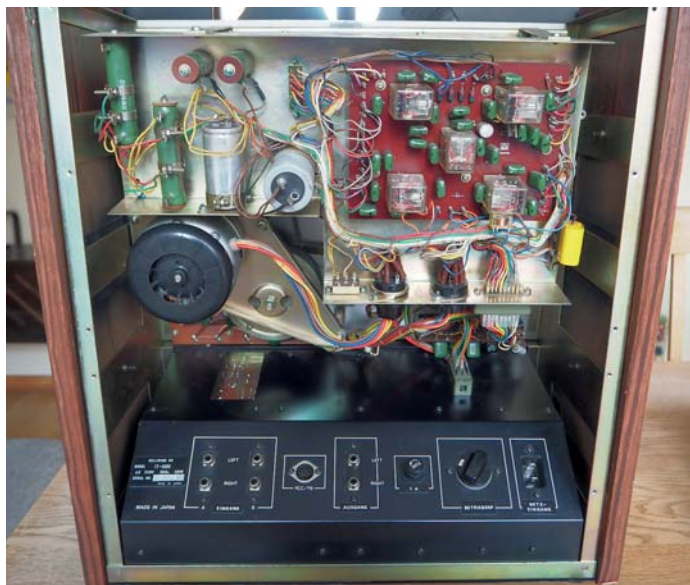
Hellwing TD-1000: Innenansicht mit Capstan-Motor, Schwungrad, Relaissteuerung
