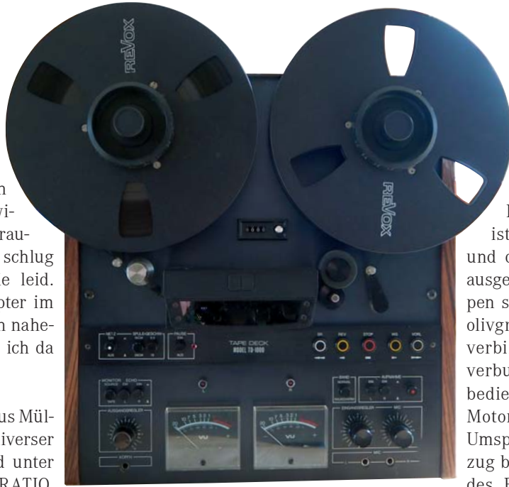
Hellwing TD-1000: Frontansicht mit originalen 27cm-Spulen und NAB Adaptern
