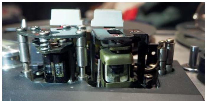
Akai GX-210D: Kombikopf für Löschen und Aufnahme, Wiedergabekopf
