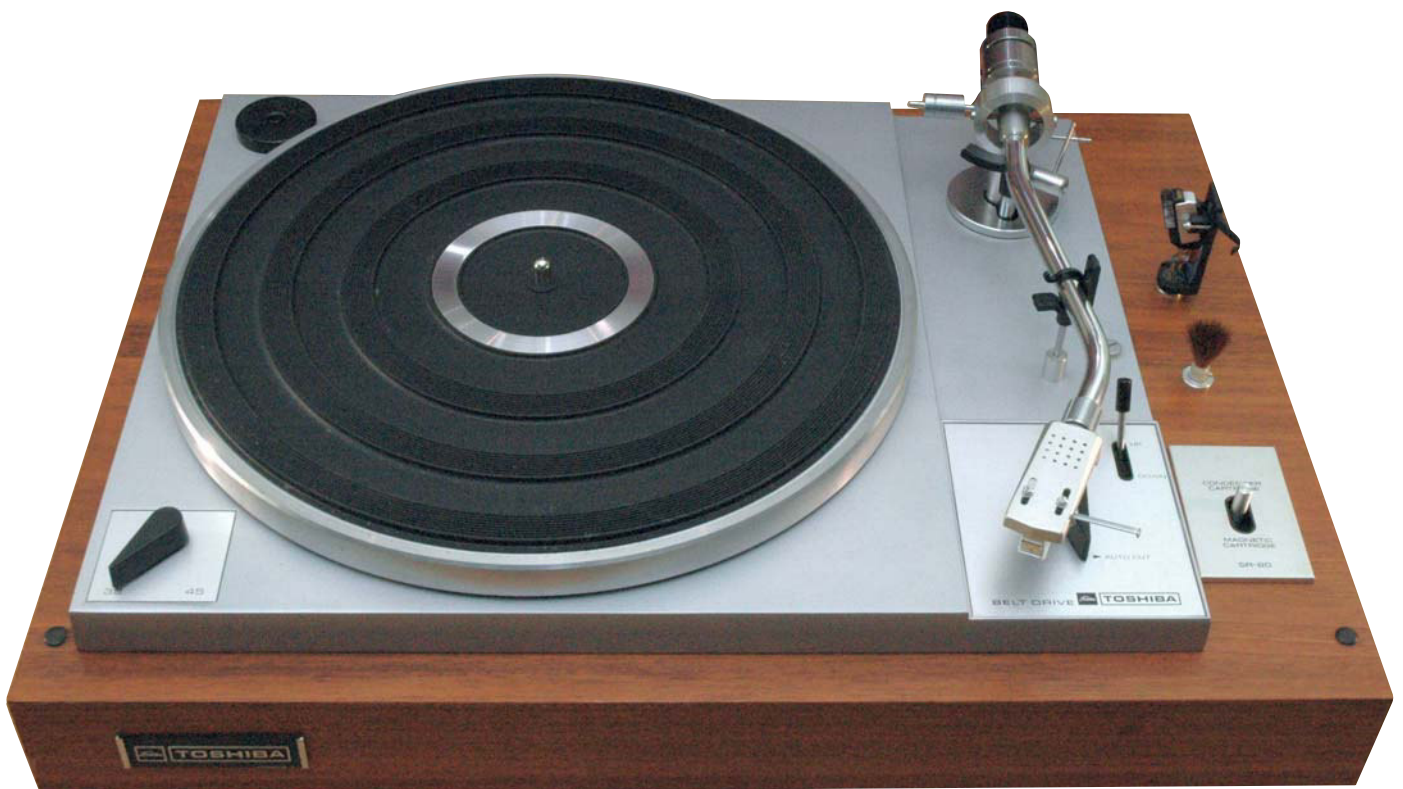
Toshiba SR-80 Plattenspieler mit Elektret-Kondensator-Tonabnehmern und eingebautem CC-Speiseteil
